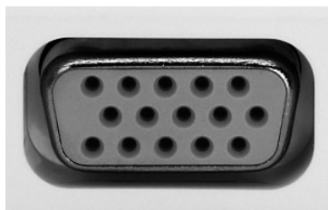
Mini D-sub 15ピン端子形状
